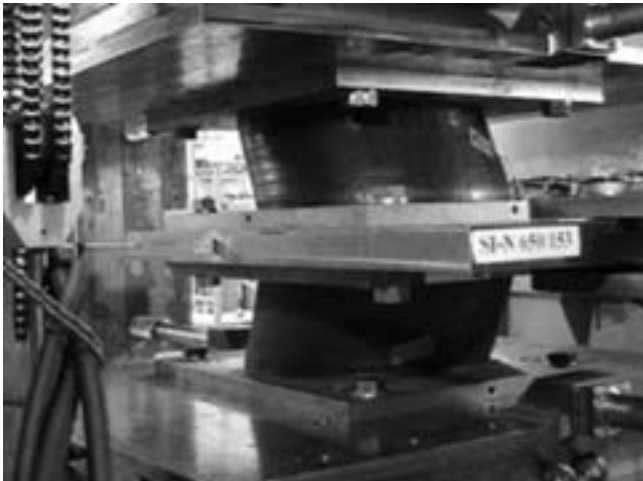
Figura 18: Due HDRB sovrapposti del nuovo corpo "B" del liceo di Figura 16 durante le prove di accettazione con deformazione trasversale sotto carico verticale costante. Il collaudo in corso d'opera è affidato allo scrivente.
