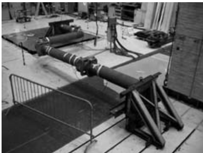
Figura 7: Prova su tavola vibrante di giunti flessibili per serbatoi isolati sismicamente (Progetto INDEPTH).
